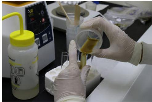
将溶液倒入粗棉布/纱布/滤茶器；轻轻按压以收集溶液。将溶液倒入离心管中。
