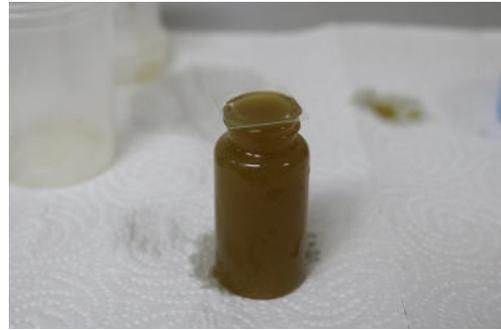
将过滤后的溶液倒入试管或 10-15mL 的窄口玻璃瓶中。再次加入漂浮液，直到正弯液面形成。将盖玻片置于瓶口。
